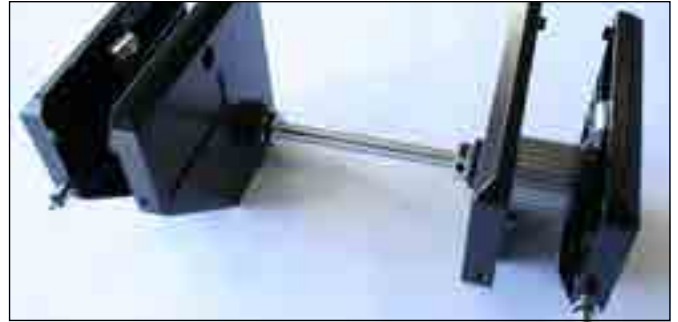
Antriebseinheit von Doppelgurtförderer mit mittigem Zahnriemenantrieb
