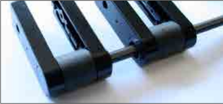
Umlenkungen Doppelgurtförderer Antriebsseite
