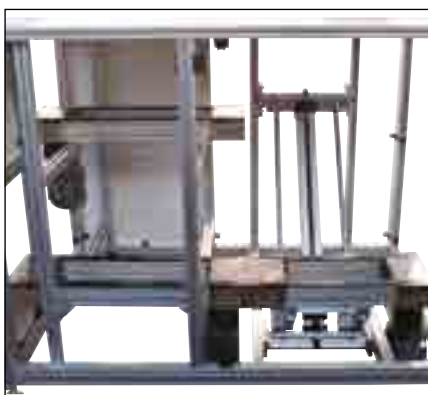
Schrägförderlift Oberflur / Unterflur (mit pneumatischem Hub)
