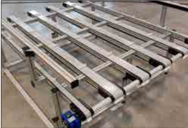
Mehrfachdoppelgurtförderer mit Zahnriemenantrieb
