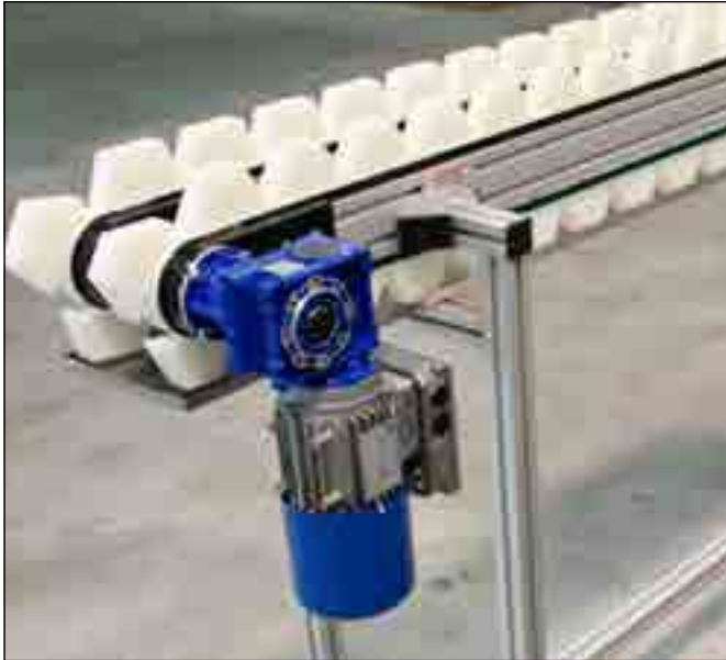
Option: Doppelzahnriemenförderer mit aufschraubbaren Mitnehmern
