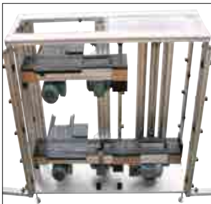
Eckförderer Oberflur / Unterflur (pneumatische Version)
