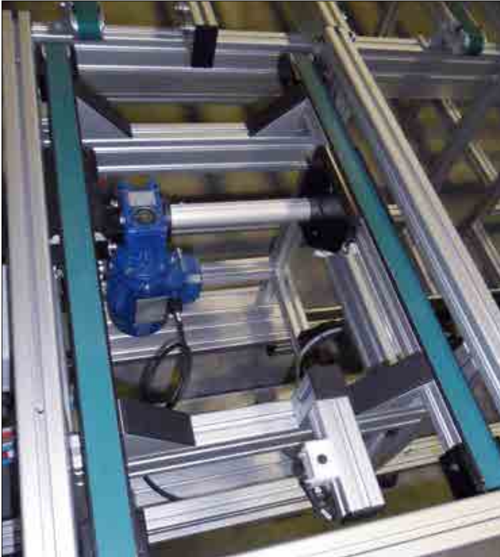
Sondereinheit: Doppelgurtförderer mit Zahnriemen als Regalbediengerät
