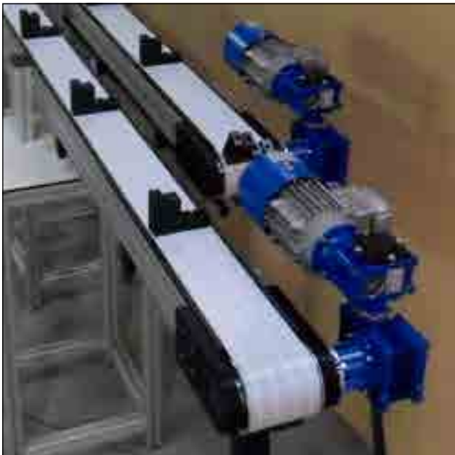
Option: Doppelzahnriemenförderer mit aufschraubbaren Mitnehmern
