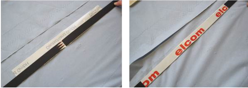
Abbildung 6: Klebestelle zum Einziehen eines neuen Gurtes
