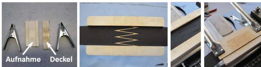
Abbildung 8: Fixierung der Schweißverbindung in der Führungseinheit (Art.-Nr.: H84779080)
