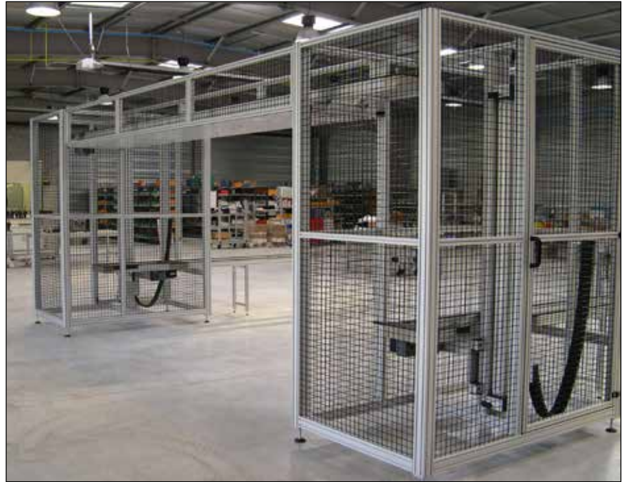
Übergangsbrücke aus zwei Hochförderern
