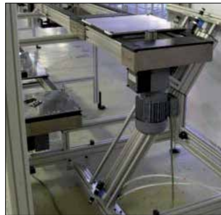
Schrägförderlift Oberflur / Unterflur
