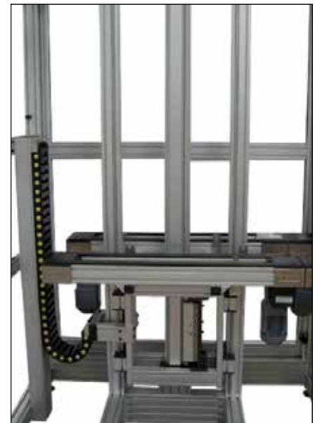
Lift für zwei Bandstrecken (von 1000 mm auf 3000 mm)
