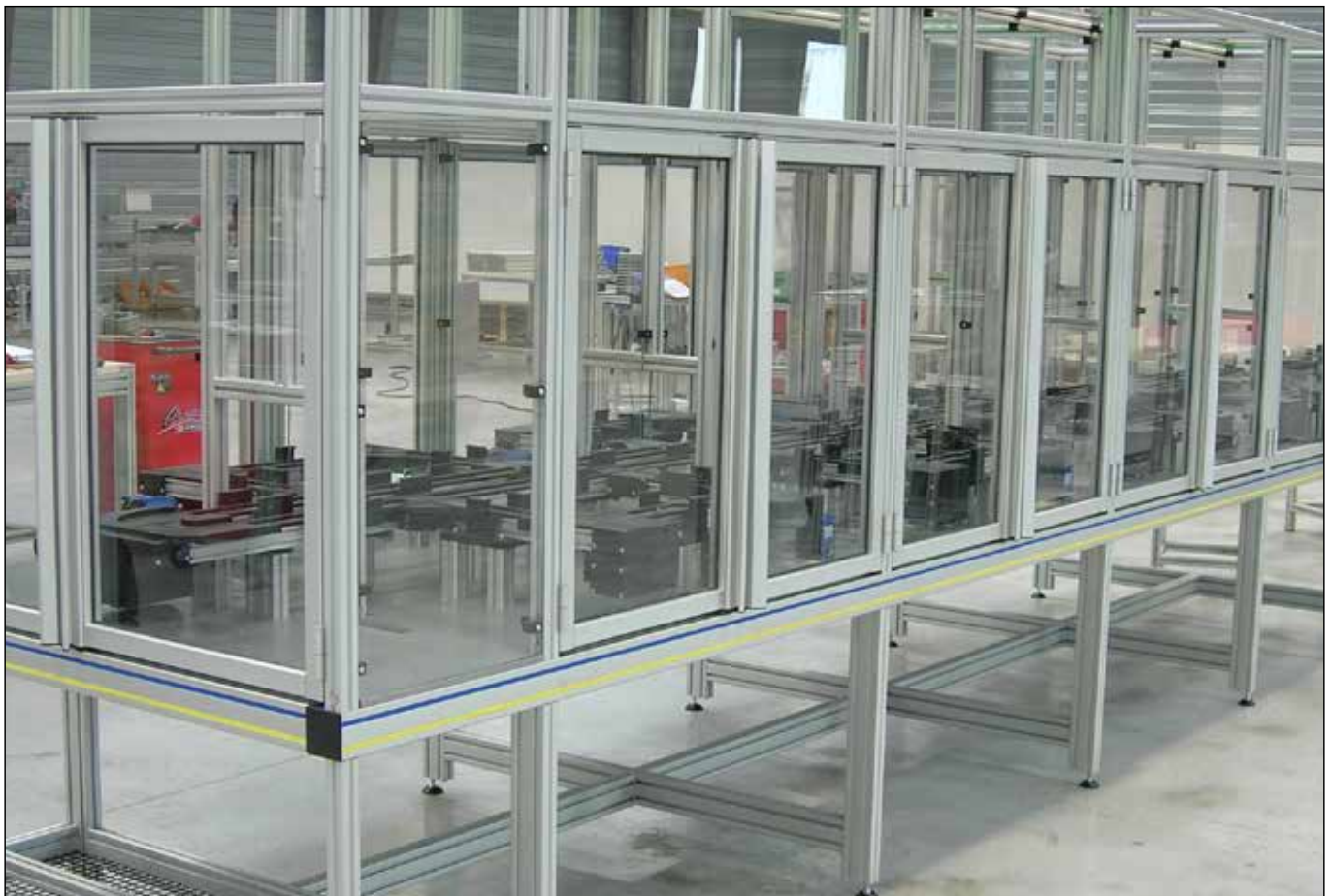
Anwendungsbeispiel für Bandstütze Tischausführung
