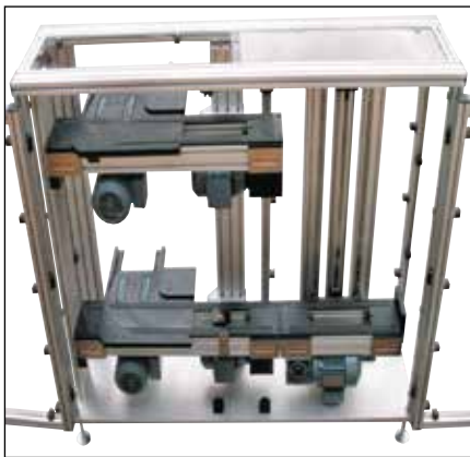
Eckförderer Oberflur / Unterflur (pneumatische Version)
