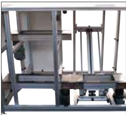
Schrägförderlift Oberflur / Unterflur (mit pneumatischem Hub)
